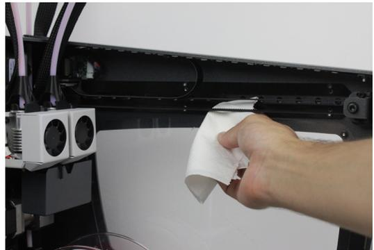
**11.** Aplicar el lápiz de aceite lubricante a lo largo de las guías lineales de los ejes X e Y, con especial énfasis en sus caras superior e inferior. Asegurarse de que no haya exceso de goteo de aceite.
