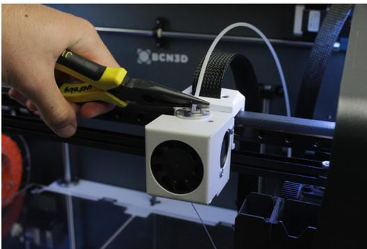
9. Repita el proceso hasta que la punta del filamento extraído del hotend esté limpia. Una vez que esté limpio, recuerde volver a colocar el tubo de teflón, el clip negro y la pieza negra.
