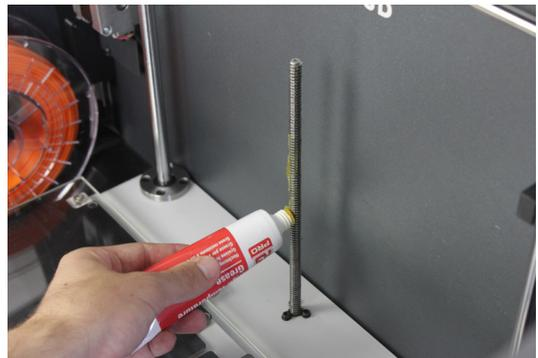
6. Encender la máquina y desde la pantalla LCD, ir a *Utilities* --> *Maintenance*--> *Move printing surface*. Subir y bajar la plataforma un par de veces para que el aceite y la grasa se distribuyan uniformemente. Finalmente, quitar los residuos de grasa.
